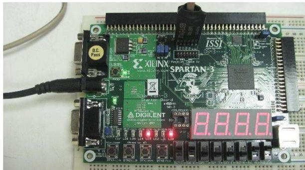
Gambar 2.1 Xilinx FPGA device Spartan 3 Keluarga/Famly FPGA jenis SPARTAN
